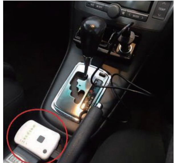
車内に設置した「GPSロガー」
